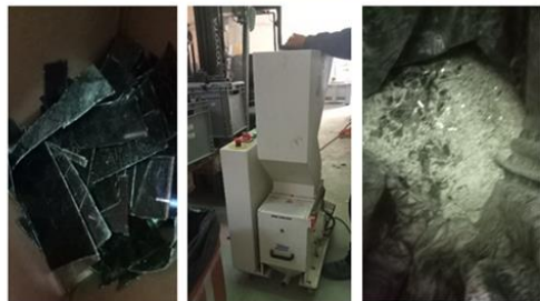
Molienda de pantallas de LCD para la extracción de indio.
